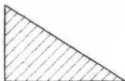
SICHTDREIECKE SIND VON JEDLICHER BEPFLANZUNG UND ABLAGERUNG ÜBER 0.80 m HÖHE ÜBER STRASSEN OBERKANTE FREIZUHALTEN, AUSGENOMMEN BÄUME, DIE BIS 2.80 m AUFGEASTET SIND.
