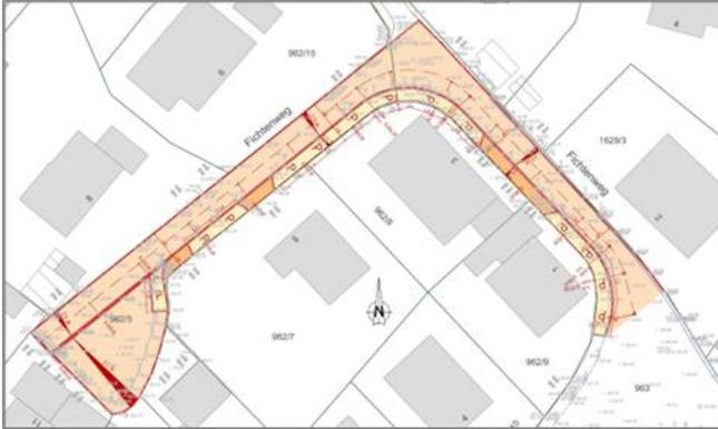
Eines der nächsten Straßensanierungsprojekte in der Gemeinde ist die Sanierung des Fichtenweges in Rudelzhausen. Der Asphalt ist stark beschädigt und weist zahlreiche Flickstellen auf. Im Rahmen des Straßenausbaus wird auch der Mischwasserkanal saniert. Zudem besteht in der Straße eine problematische Parksituation. Parkende Autos blockieren die Durchfahrtsbreiten für Rettungsfahrzeuge.
